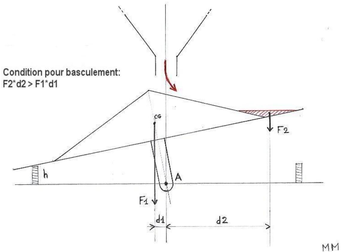
C'est le principe d'une bascule stable / instable, c'est à dire dont le centre de gravité (CG) se trouve nettement au dessus de l'axe de rotation (A).
